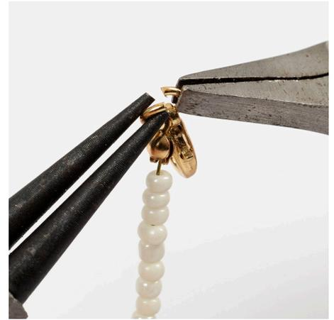
**6** Refermez la boucle ronde. Terminez en serrant la boucle ronde avec une pince plate pour vous assurer que les pièces restent en place. Répétez le processus à l'autre extrémité du bracelet et du collier, juste sans le fermoirs mousquetons.
