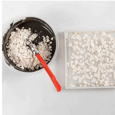
**7** Déposer une couche de flocons de terrazzo sur le fond du moule. Mélangez le reste des flocons dans le composé de moulage coloré. Diluez avec un peu d'eau si nécessaire.
