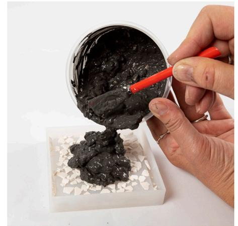
**8** Verser la préparation dans le moule. Empêcher les flocons de terrazzo de s'accumuler sur un côté du moule. Remplissez jusqu'à 1-2 mm du bord.
