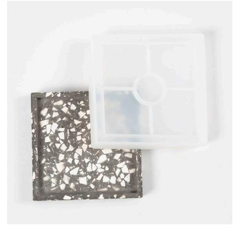
**11** Laissez durcir le composé de moulage dans le moule. Cela prend environ 90-240 minutes et dépend principalement de la quantité d'eau que vous avez mélangée. Une fois durci, il doit être facile à retirer du moule.
