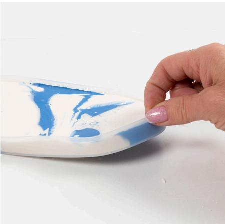
**10** Lorsque le moule est plein, les bulles d'air doivent être éliminées. Soulevez les extrémités et les côtés du moule un par un. Répétez l'opération pendant environ 3 minutes afin que les bulles d'air remontent à la surface et que les couleurs se mélangent.
