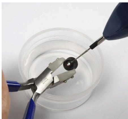
**No. 13102** Un alésoir C'est un outil à piles spécial pour agrandir le trou des perles et enlever les résidus indésirables. Maintenez la perle et la pointe de la fraise dans un peu d'eau et poncez toutes les bosses dans l'orifice de la perle. La pointe de la fraise est conique et cet outil est livré avec deux poinçons. Vous aurez besoin de 2 piles AA lesquelles ne sont pas incluses.
