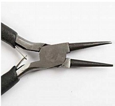
**No. 13016** La pince à bec plat et rond La pointe longue et ronde est utilisée pour tendre du fil et des épingles à tête. La taille de la boucle effectuée avec la pince à bec plat et rond dépend de la partie de la pointe qui est utilisée pour former la boucle. Si vous désirez confectionner plusieurs boucles de la même taille, vous pouvez dessiner une ligne au marqueur sur l'endroit exact de la pointe de la pince à bec plat et rond.
