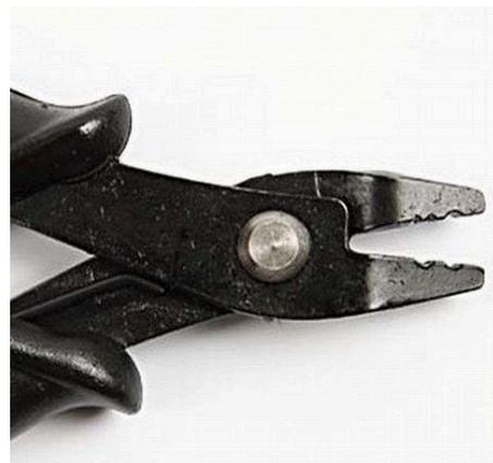
**No. 13042** Pince de sertissage Cet outil permet de rendre la fermeture d'une perle à écraser encore plus petite que lors de l'utilisation d'une pince à bec plat. Elle peut également être utilisée pour bien placer l'extrémité d'un fil coupé lors de la confection d'une bobine de fil ou d'une épingle à tête.
