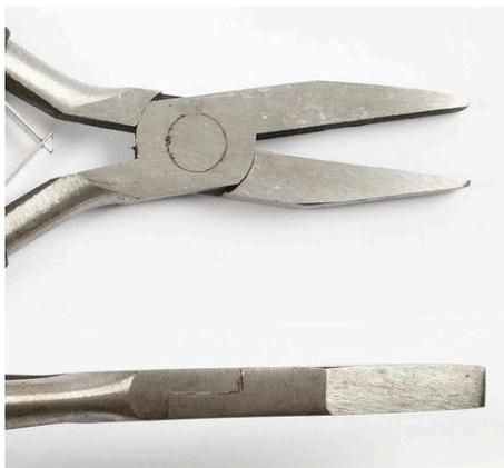
**No. 13014** La pince à bec plat Elle peut être utilisée pour tenir, pour ouvrir et pour fermer des boucles rondes. Le bec est plat à l'intérieur comme à l'extérieur.
