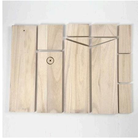
**3.** Percez un trou pour accrocher en haut et au dos de la boîte ainsi qu'un trou à la base de la boîte pour le drainage (dans un coin). Utilisez une scie à trou à l'avant de la boîte pour faire un trou pour l'entrée. Placez-le à environ 20 cm de la base ce qui permettra de faire un meilleur abri et espace pour la construction du nid. Suivez les instructions et aidez-vous de la photo.
