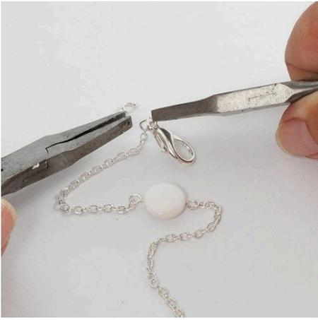
**4.** Bracelet : enfilez une perle sur un épingle à œil, lequel est raccourci et plié en faisant un autre œillet à l'aide d'une pince à bec plat rond. Une chaîne articulée est montée des deux côtés de la perle - en ouvrant et refermant 1 articulation. Montez un fermoir mousqueton à l'aide d'un anneau ovale sur les deux côtés.
