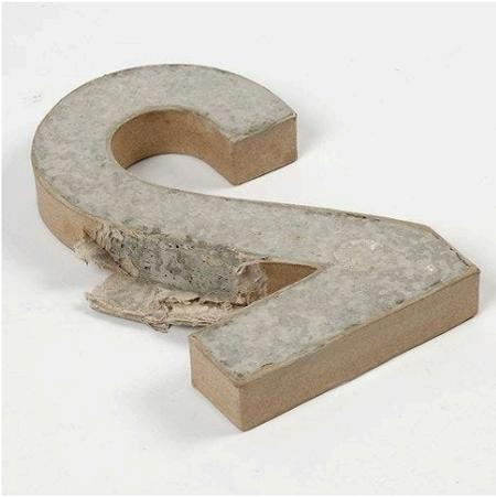
**4.** Sortez la forme en béton du moule. NB: Il est peut-être nécessaire de casser le moule en papier mâché afin d'en sortir la forme. Nettoyez le chiffre coulé et éliminez les résidus de papier mâché.
