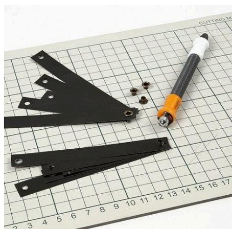
**2.** Assemblez toutes les bandes en une extrémité en insérant un œillet dans tous les trous à la fois. Retournez-les et aplatissez les côtés sur l'œillet en utilisant le côté opposé du poseur d'œillets.
