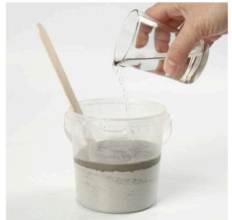
**3.** Mélangez la poudre de béton avec de l'eau dans le rapport: 1 partie d'eau à 10 parties de poudre de béton. NB: Le plus d'eau, la plus brillante le résultat.
