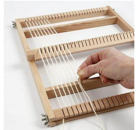
**3.** Placez les fils de la chaîne dans les rainures des blocs transversaux en haut et en bas du métier à tisser. NB: Le fil de la chaîne passe dans toutes les rainures situées dans le bloc du milieu.
