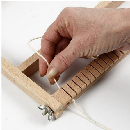
**2.** Placez le fil avec le nœud dans la rainure du bloc inférieur du métier à tisser. Placez le bloc mobile à peu près au milieu du métier.
