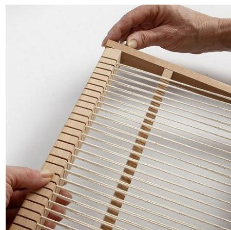
**9.** Desserrez les écrous papillons de chaque côté du bloc inférieur et effectuez une torsion pour serrer tous les fils de la chaîne du métier. Resserrez les écrous papillons. Le métier à tisser est maintenant prêt.
